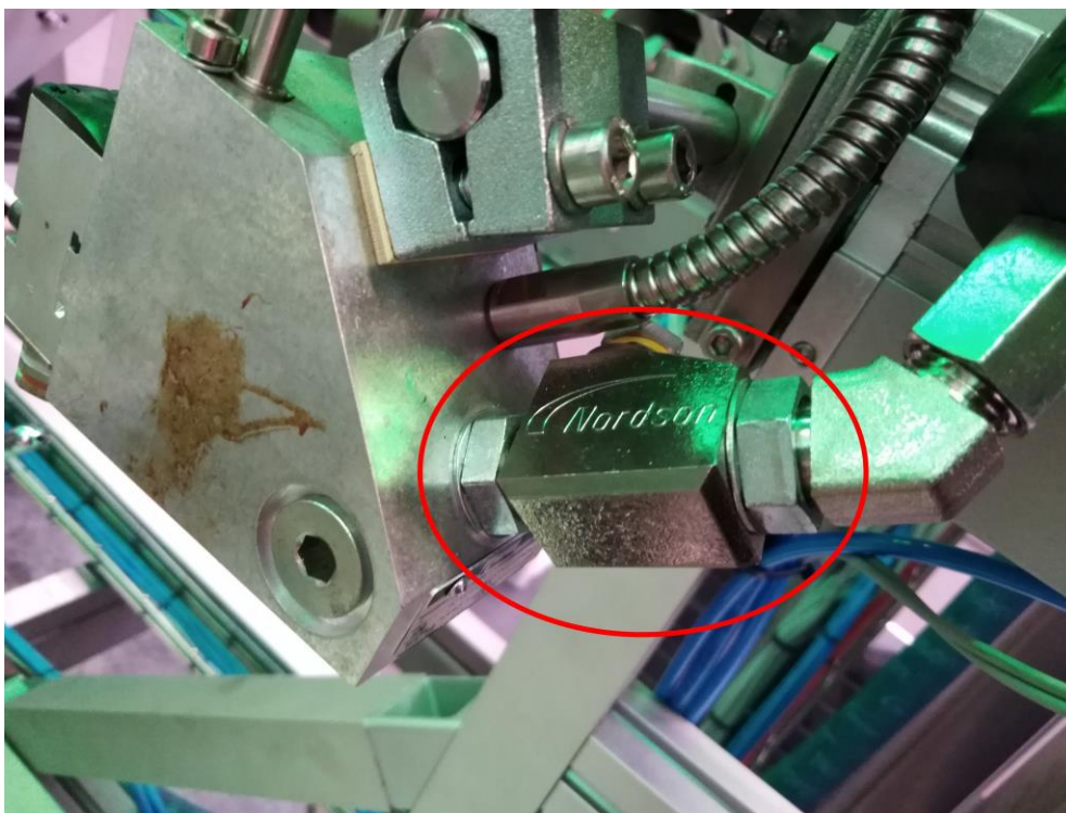
Rys. 3.6 Zaznaczony filtr kleju na podwójnej dyszy
