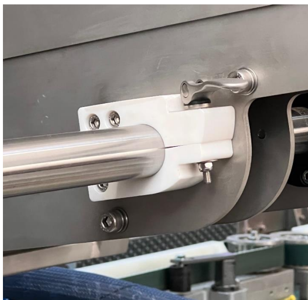
Rys. 26 Zacisk ustalający położenie lewej strony zasobnika
