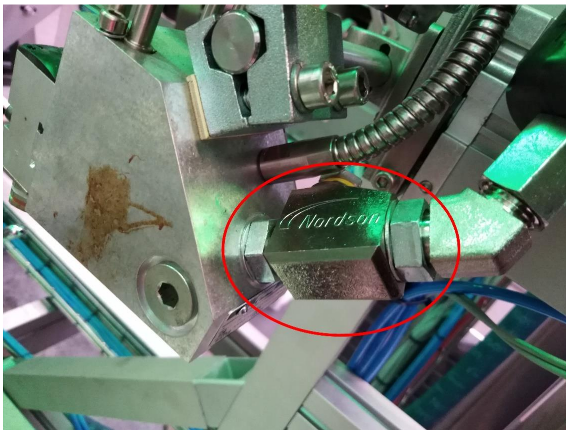
Rys. 42 Umieszczenie filtra kleju na głowic podwójnej
