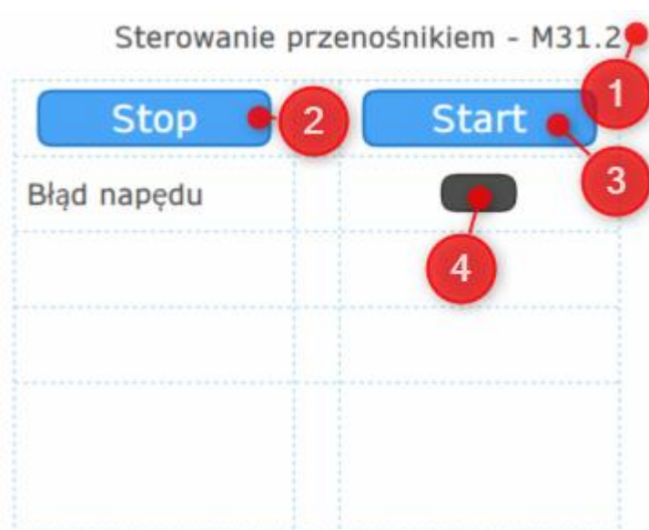
Rys. 51.2 Widok strony tryb ręczny dla przenośników
