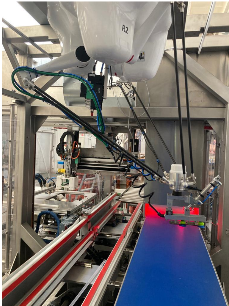
Rys. 20 Ułożenie przewodów na ramionach robotów R1 i R2
