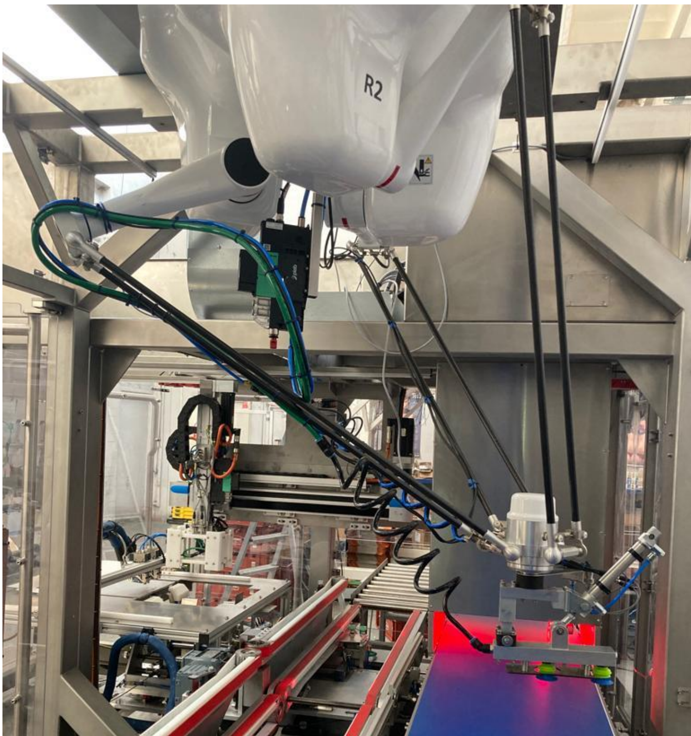
Rys. 5 Pozycja transportowa robotów R1 i R2
